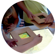
Поларизујући филтри показују обојене шаре упрозирној пластици изаженојнапрезању.
